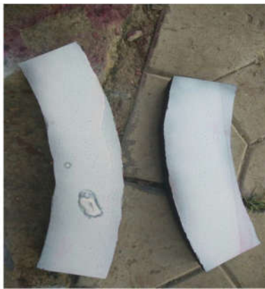
图 4 WB36 钢管低倍组织缺陷试片磁粉探伤照片
